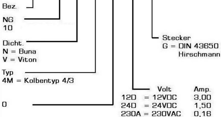
Die Wechselstromspulen (230A) haben den Gleichrichter mit integriert
