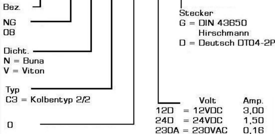
Für Wechselstromspulen (230A) benutzen sie Stecker mit integriertem Gleichrichter DIN 20828
