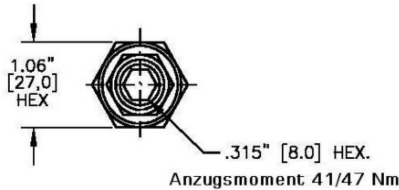
Verstellschraube im Uhrzeigersinn drehen für Erhöhung der Druckeinstellung
